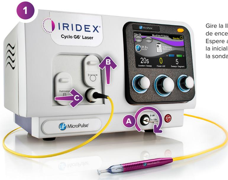
1 Gire la llave a la posición de encendido (“ON”). Espere a que se complete la inicialización. Conecte la sonda MicroPulse P3.
